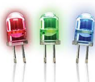
Slika 2: LED žarnice različnih barv, z njihovo kombinacijo ali posebnimi premazi pa lahko sevajo belo svetlobo.
