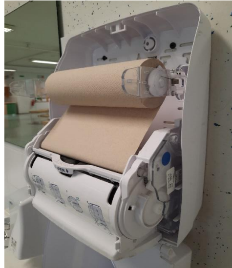
SLIKA 4: Podajalni sistem v podajalniku.
