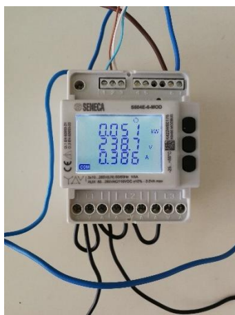
SLIKA 3: Merjenje delovne moči, napetosti in toka (vir: Lasten).
