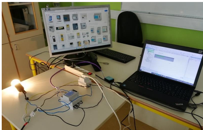
SLIKA 8: Merjenje poraba električne energije šolskega računalnika (vir: Lasten).
