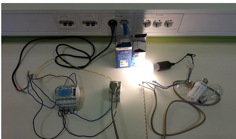
SLIKA 9: Testiranje porabe električne energije različnih virov svetlobe (vir: Lasten).
