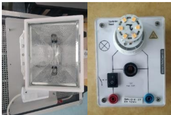
SLIKA 4: Halogenski 500 W reflektor. SLIKA 5: Modul za žarnico s stikalom.
