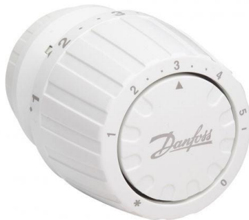
SLIKA 3: Primer termostatske glave, ki po potrebi samodejno poveča pretok grelnega medija skozi ogrevalno telo. V primeru nastavljenе temperature pa pretok ogrevalnega medija ustrezno zmanjša.
