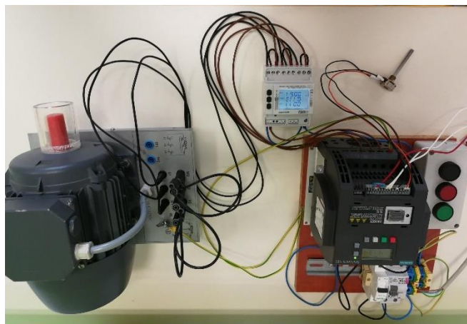
SLIKA 4: Merjenje delovne, jalove in navidezne moči (vir: Lasten).
