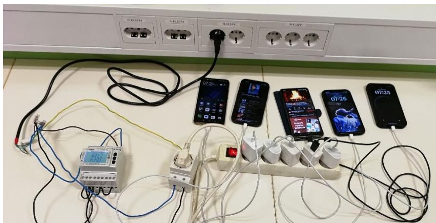
SLIKA 7: Merjenje poraba električne energije pri polnjenju mobilnih telefonov (vir: Lasten).
