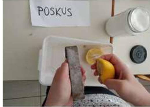
SLIKA 6: Poskus: odstranjevanje rje s soljo in limono.
