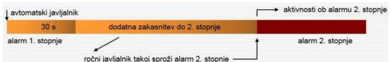
SLIKA 4: Protokol v primeru aktiviranja požarne centrale.
