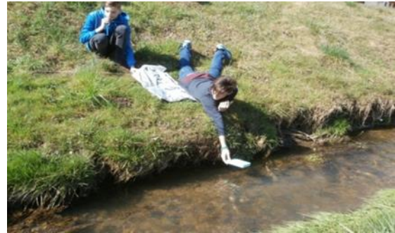
Slika 7: Merjenje hitrosti vodnega toka.
