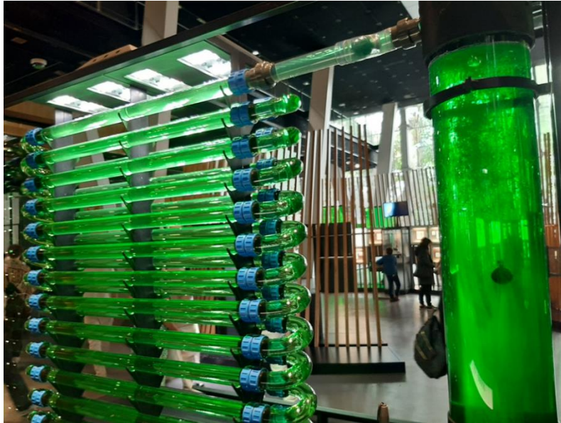
SLIKA 4: Bioreaktor za proizvodnjo algne biomase. (Vir: lasten).
